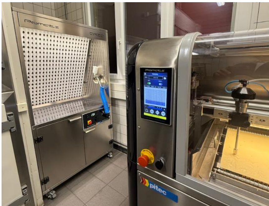
Links die Sprühkabine Aria, rechts der Pomati-Aqua-Wasserstrahlschneider – zwei zentrale Elemente des neuen Produktionsbereichs von Ackermann Artisan.
