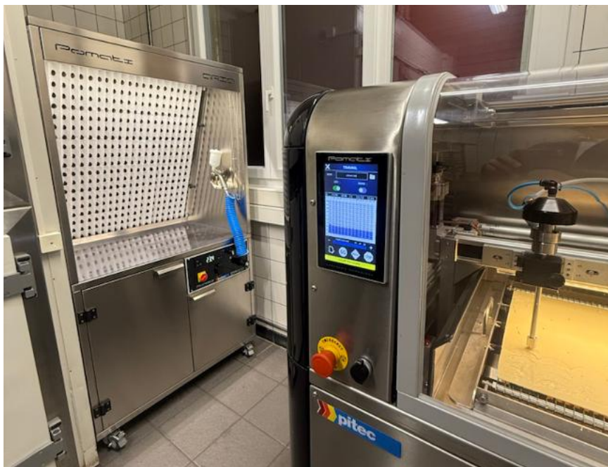
À gauche, la cabine de pulvérisation Aria, à droite la découpeuse à jet d'eau Pomati Aqua – deux éléments centraux du nouvel espace de production d'Ackermann Artisan.
